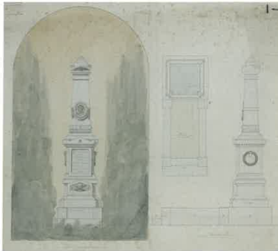
▲ Presentatiekening I-13 (potlood en aquarel) van een blauwhardstenen grafteken — een vlakke steen en cyppe waarop obelisk — met portretmedaillon, doodshoofd met gekruiste tibia's, uil en bloemenkransen. Vooraanzicht, suggestief omringd door cypressen, grondplan en zijaanzicht. Het ontwerp is gesigneerd Louis Vanlangendonck arch. en draagt de stempel van E. Beernaert, Renbaanlaan 131-133 (Epitaaf vzw, fonds Beernaert)
