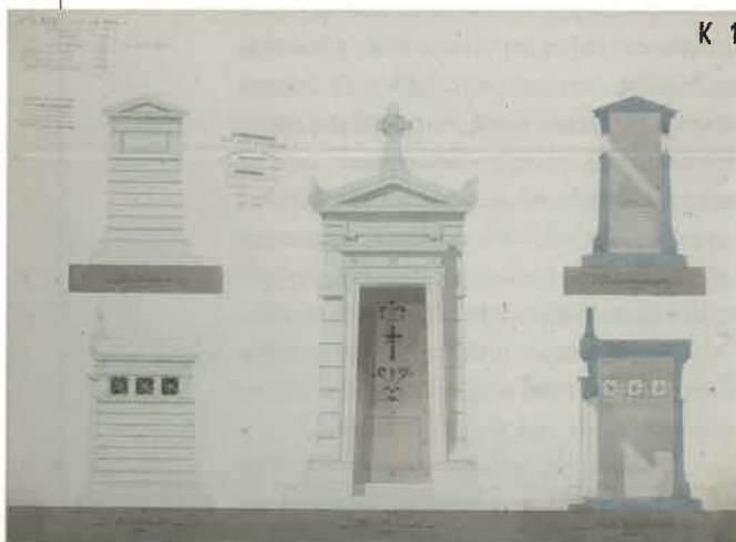
▼▼▼ Presentatiekening K15 (potlood en aquarel) van een klassicerende, trapezoidale grafkapel (vooraanzicht, zijaanzicht, achterzijde, dwars- en langsdoorsnede) voor de familie Reisse, blijkens één der stempels ontstaan ten tijde van de overgang van de Wiertzstraat naar de Renbaanlaan (Epitaaf vzw, fonds Beernaert). Van dit model bestaat tevens een fraaie gipsen maquette. Foto's tonen aan dat de kapel in meerdere varianten werd uitgevoerd (Epitaaf vzw, fonds Beernaert)
