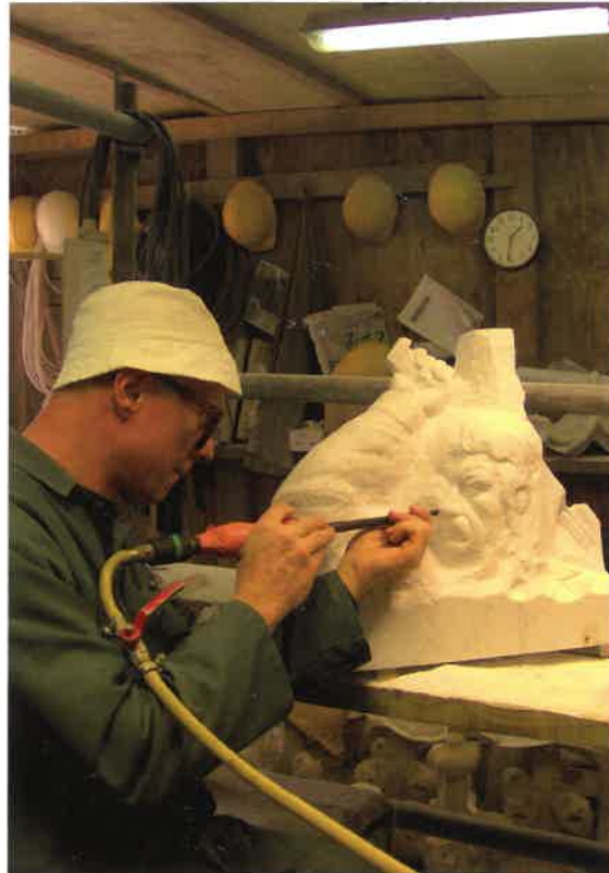
◀ Bas-reliëf met de aanval op het stadspark: hoofd en degen van een Hollandse officier; het oorspronkelijk model in het atelier Ernest Salu; het nieuw model in klei; de overbrenging naar marmmer met behulp van een driehoekspasser en pneumatische beitel (foto's Regie der Gebouwen)
