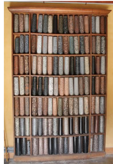
De granietkast, vandaag eigendom van Epitaaf vzw, bestaat uit meer dan honderd cilindrische granietstalen
