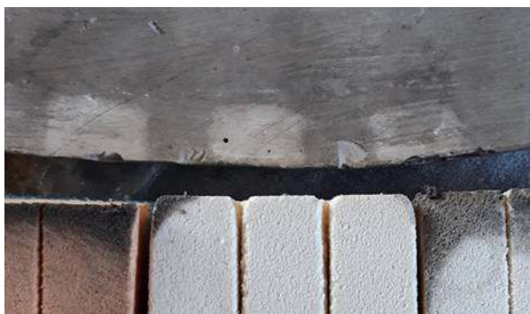
Tests de nettoyage à l'aide d'éponges vulcanisées à différente dureté (© Laura Porcu)
